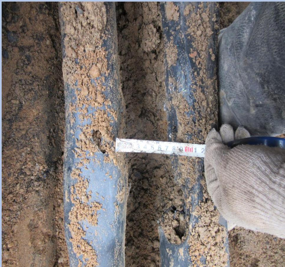
Из-за ухудшения изоляционных свойств и короткого замыкания соединительной муфты, установленной на кабельной линии 10 кВ, произошел наружу выброс продуктов горения электрической дуги.
